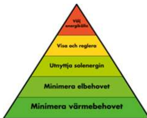
Figur 5 "Kyoto pyramiden" för hållbar energianvändning i byggnad
